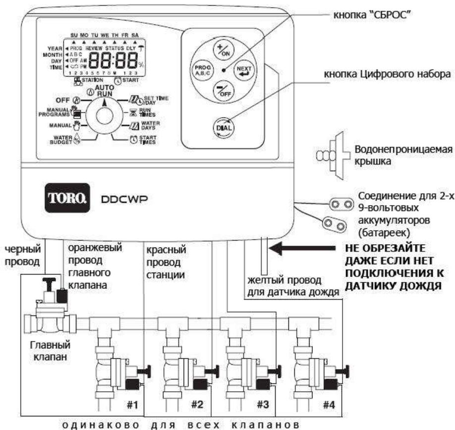
После подключения проводов станции, снимите водонепроницаемую крышку с аккумуляторного отсека и извлеките две клеммы для 9-вольтовых аккумуляторов постоянного тока.
