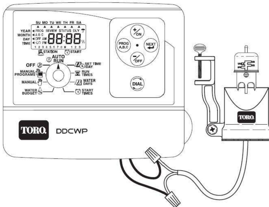
Контроллер DDCWP взаимодействует с проводным датчиком дождя TORO TRS wired Rain Sensor. Разрежьте петлеобразный желтый провод контроллера, и, используя водонепроницаемые коннекторы, соедините концы с двумя желтыми проводами датчика дождя. Контроллер будет взаимодействовать с нормально замкнутым датчиком дождя. Следуйте инструкциям производителя по установке. Активация датчика дождя обнуляет все программы полива до тех пор пока датчик дождя не будет отключен.
