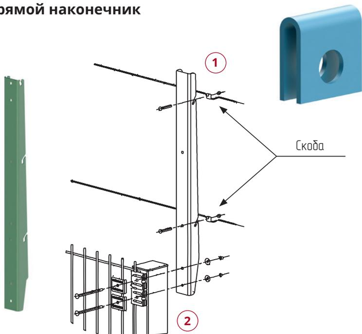
1. При креплении прямого наконечника на панельное ограждение, панель ограждения зажимается во вкладыше крепления скоба-болт, наконечник крепится с обратной стороны столба.
