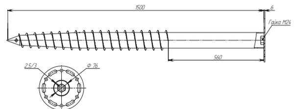
Винтовая опора на фланце 1,5 м
