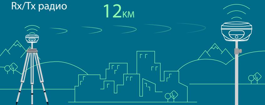
Встроенный радиопередатчик может охватывать диапазон до 8-12 км, при использовании фирменного протокола Lora. AP10 работает как база и ровер, а при подключении к сети GNSS RTK он становится эффективным ровером в режиме получения поправок через NTRIP.
