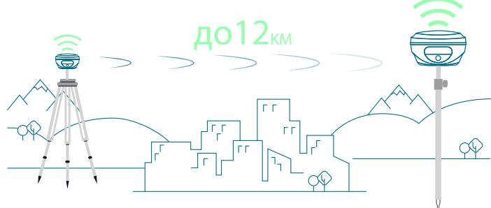
Встроенный интегрированный приемо-передающий радиопередатчик может охватывать диапазон 8-12 км. AP50 работает как база и ровер по УКВ, а при подключении к сети GNSS RTK он становится эффективным ровером в режиме получения поправок через NTRIP.
