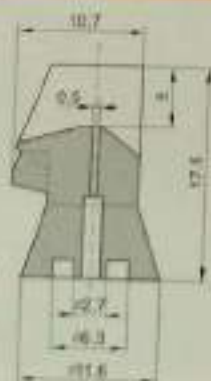
Oiling Nozzles / 上油嘴
