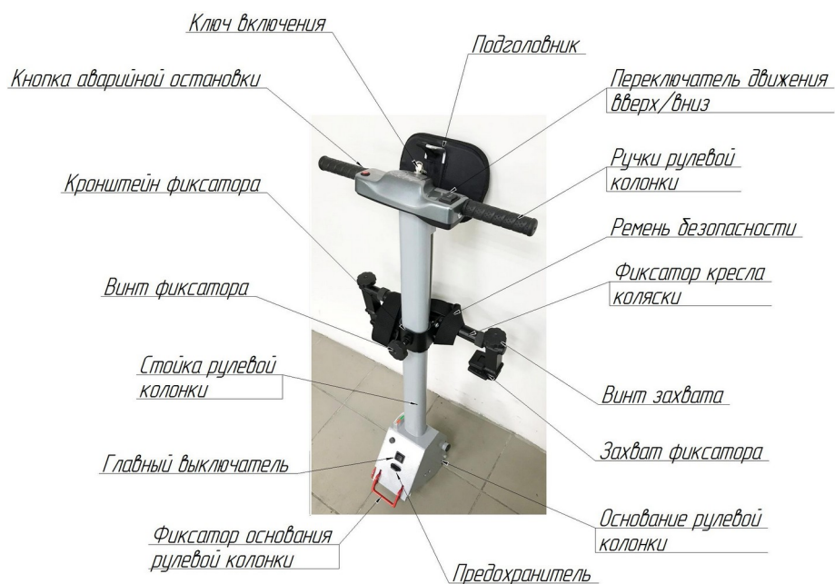
Рис.19. Рулевая колонка с фиксатором кресла-коляски
