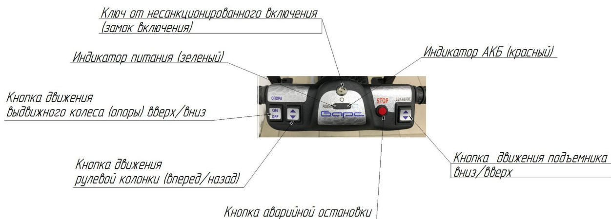
Рис.6а. Элементы системы управления на панели приборов
