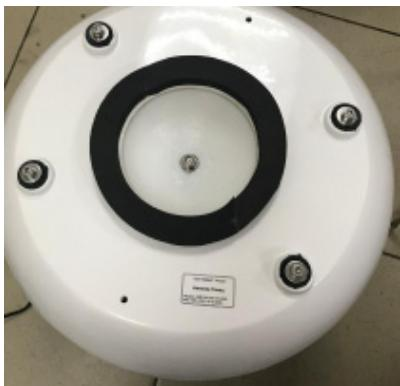
Антенна оснащена разъемом TNC, аналогично разъему штатной антенны системы «Гонец». В нижней части основания РПУ предусмотрены 4 отверстия с резьбой М6 для крепления антенны на судне. Для удобства монтажа антенна опционально может поставляться с металлическим креплением для установки на вертикальную трубу диаметром до 49 мм (труба с широким фланцем).
