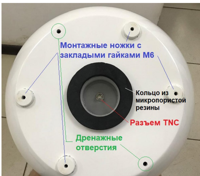
Рис. 2 Размещение разъема TNC на нижней стороне РПУ, уплотнительное кольцо из микропористой резины, закладные гайки М6 для монтажа антенны на крепление КГ-02.
