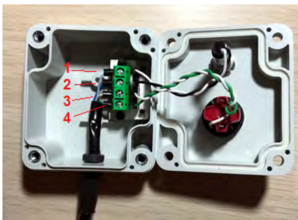
Рис. 1.5.3 Рекомендуемая расцветка жил кабеля UTP/FTP/SFTP для подключения кнопок SSAS1 и SSAS2
