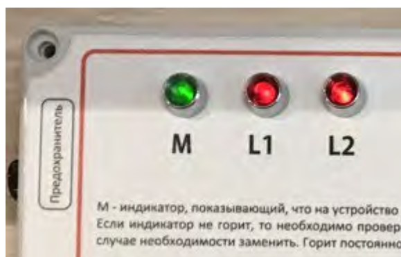
Рис. 1.4.7 Индикатор М, L1, L2 на верхней крышке БУД
