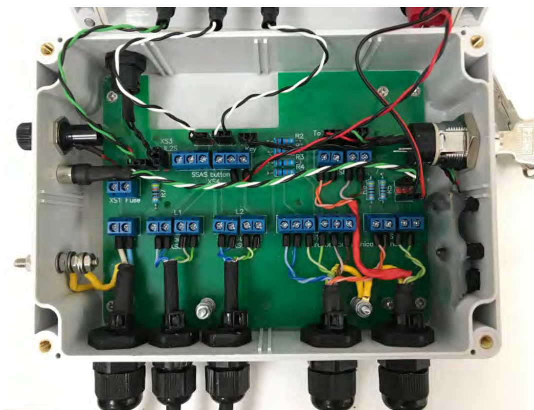
Рис. 1.4.15б Образец подключения проводов на плате БУД (с 2-мя кнопками SSAS и одной кнопкой DISTRESS)
