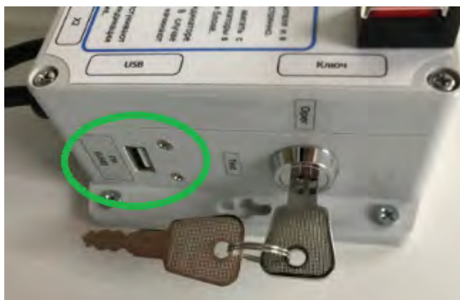
Рис. 1.4.11 Разъем USB для подключения к компьютеру
