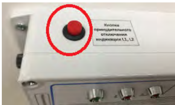
Рис. 1.4.6 Кнопка принудительного отключения индикации L1, L2
