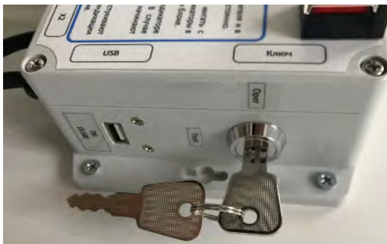
Рис. 1.4.8 Ключ переключения режимов работы OPER/TEST
