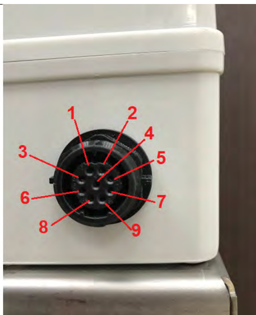
Рис. 1.3.3 Назначение контактов разъема № 2
