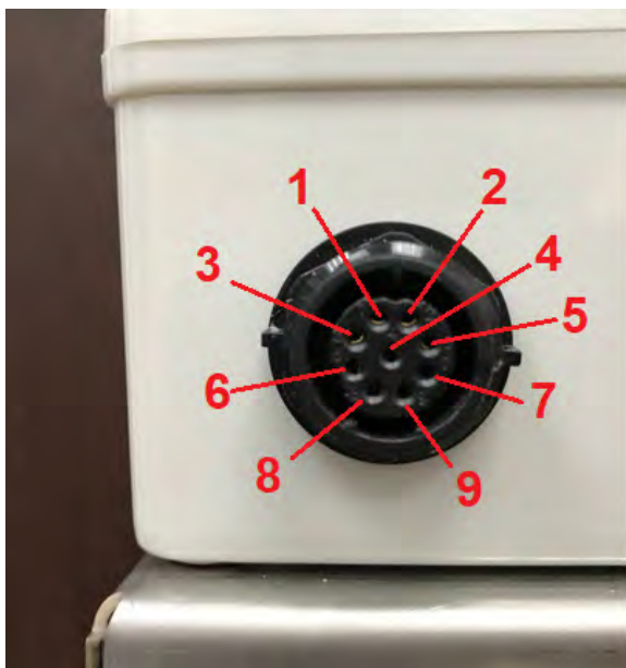
Рис. 1.3.2 Назначение контактов разъема № 1
