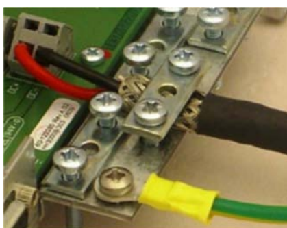
Рис. 9.6. Вариант подключения с заземлением через прижимную планку ИП.
