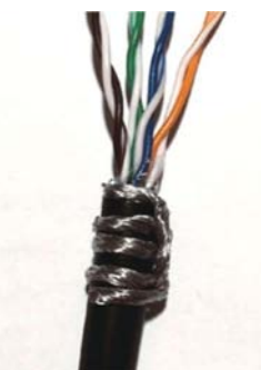
Рис. 9.6. Вариант подключения с заземлением через прижимную планку ИП.
