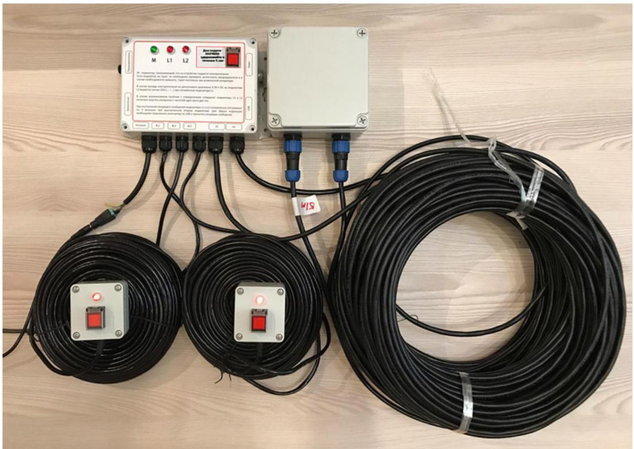
Под верхней крышкой гермобокса приемопередатчика располагаются антенны GPS/GLONASS, Iridium SBD, GSM. Устройство должно быть размещено на открытой палубе в горизонтальной плоскости. Для стабильной работы достаточно  $\frac{1}{4}$  верхней полусферы открытого неба.
