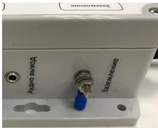
Рис.6 Штырь заземления на корпусе
