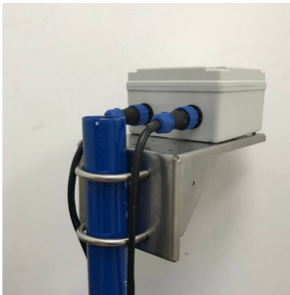
Рис. 3 Основной блок на Г-образном креплении
