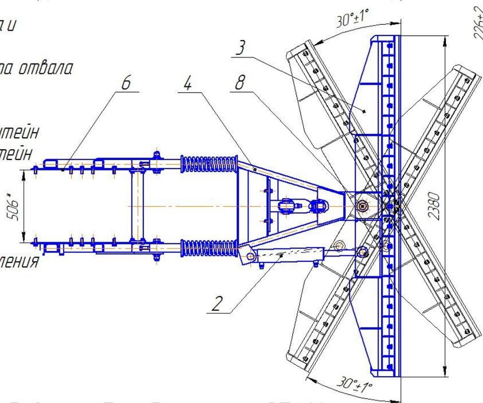
Рис.1 Оборудование бульдозерное ОБ-16
