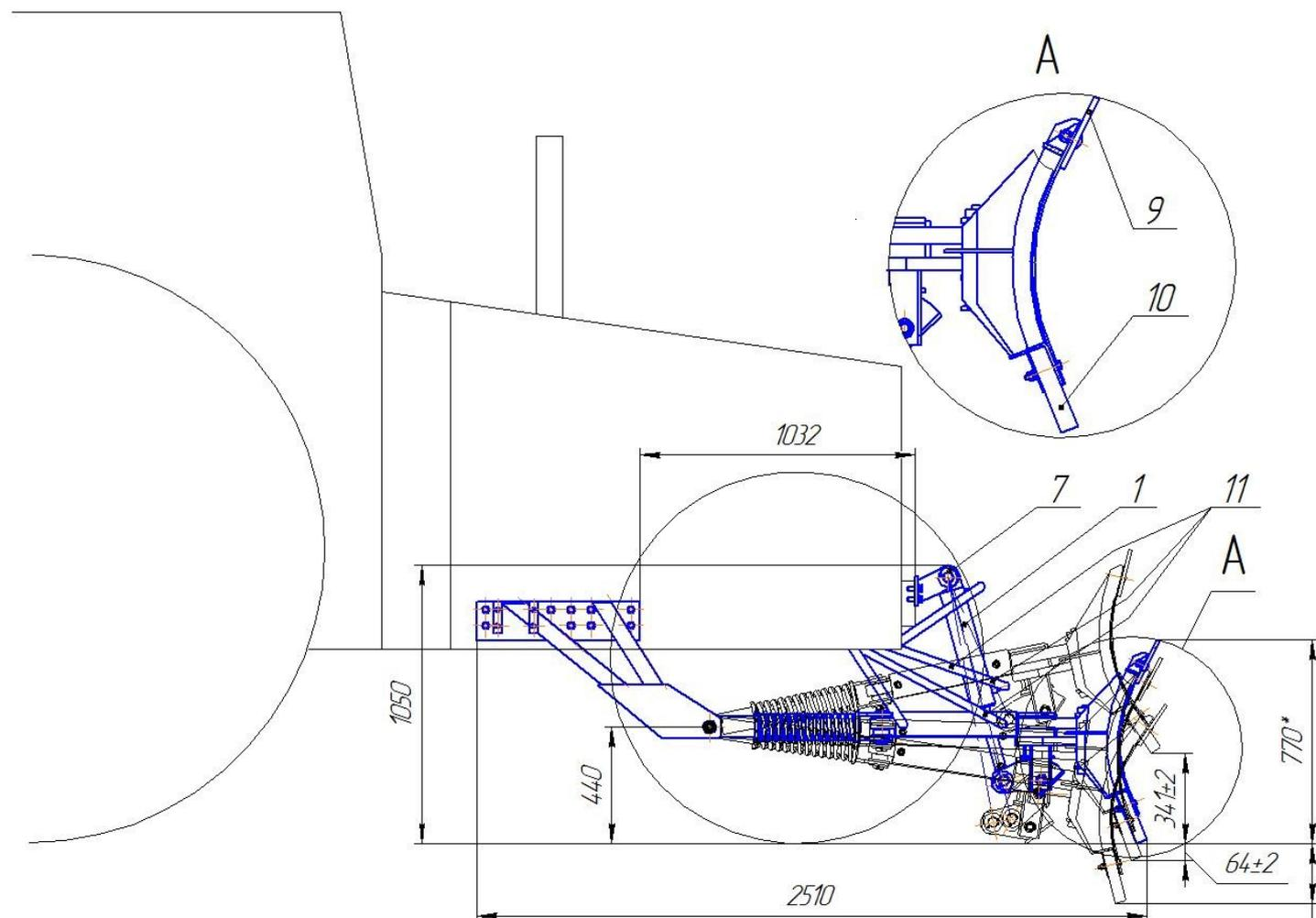
1. Гидроцилиндр подъёма и опускания отвала
