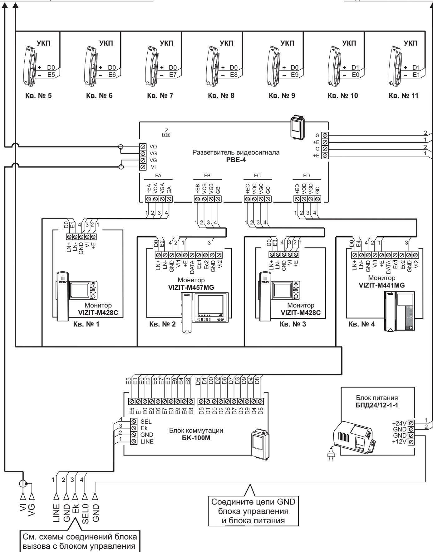
**Примечание.** Рекомендации по расчёту допустимого количества мониторов, подключаемых к одному блоку питания **БПД24/12-1-1** приведены в инструкции по эксплуатации разветвителя видеосигнала **PBE-4**.
