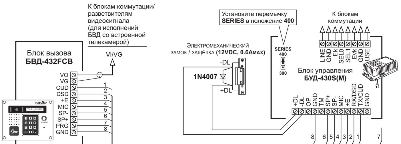
**Примечание.** Подключите провод PRG к клемме GND блока управления при записи МАСТЕР-ключа №1 блока вызова. Отключите провод после окончания записи МАСТЕР-ключа.
