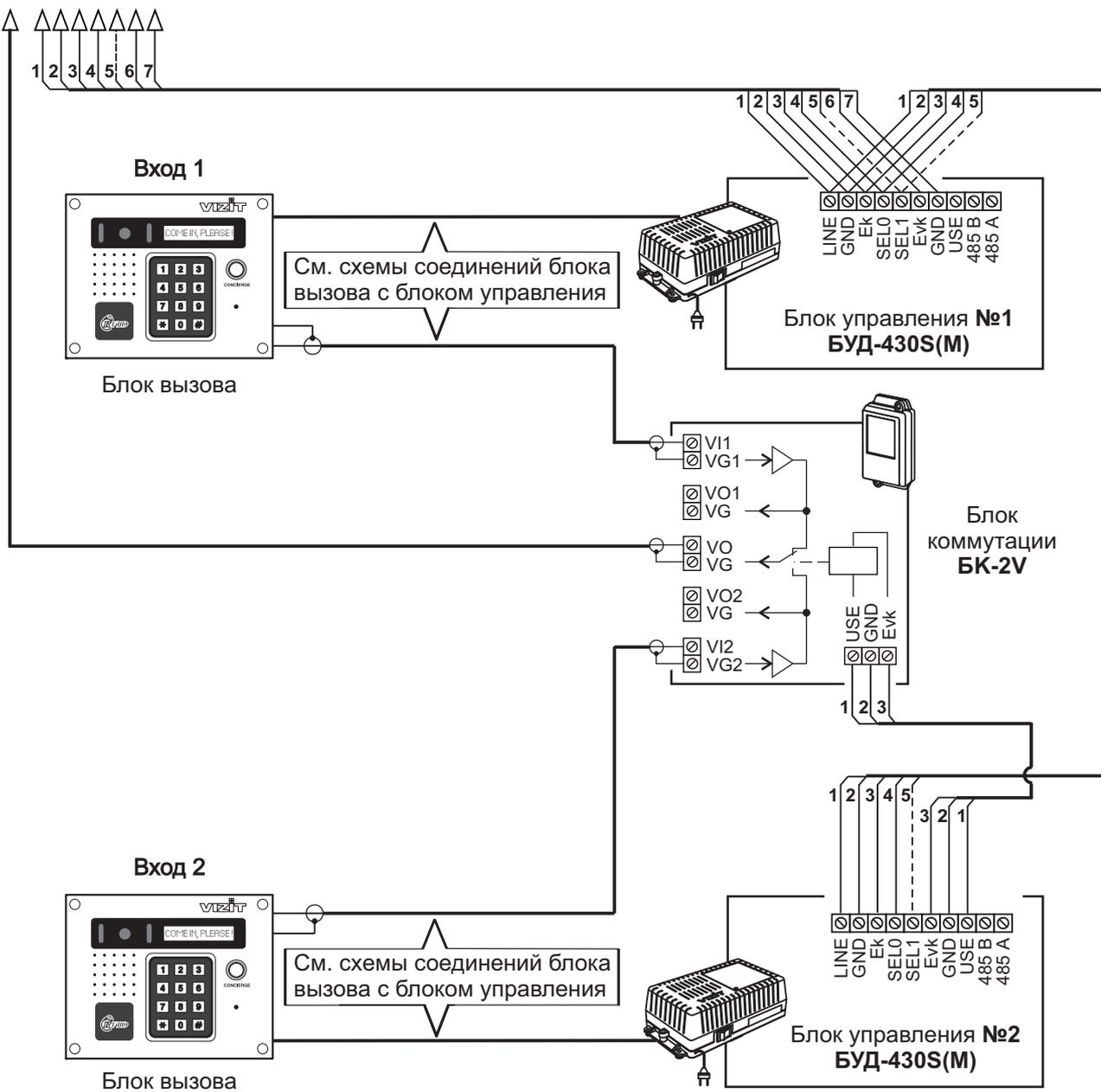
Схема соединений двух блоков управления в составе многоквартирного видеодомофона
