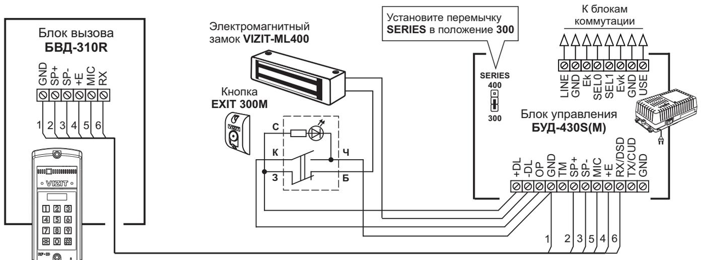
**Схема соединений блока вызова БВД-310R с блоком управления, электромагнитным замком VIZIT-ML400 и кнопкой EXIT 300M**
