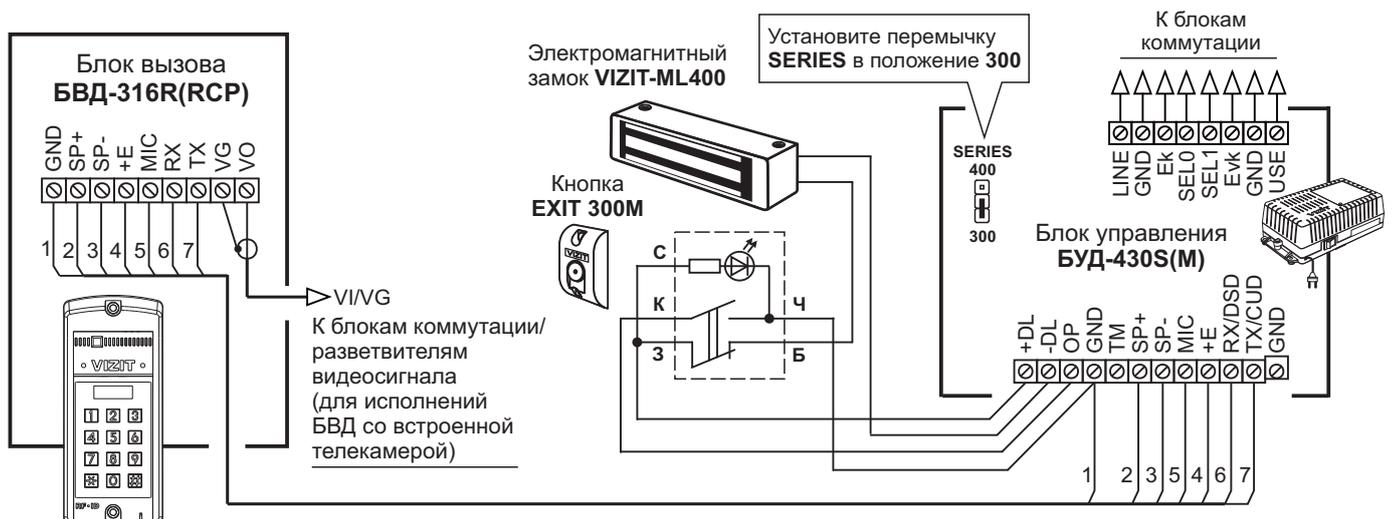
**Схема соединений блока вызова БВД-316R(RCP) с блоком управления, электромагнитным замком VIZIT-ML400 и кнопкой EXIT 300M**
