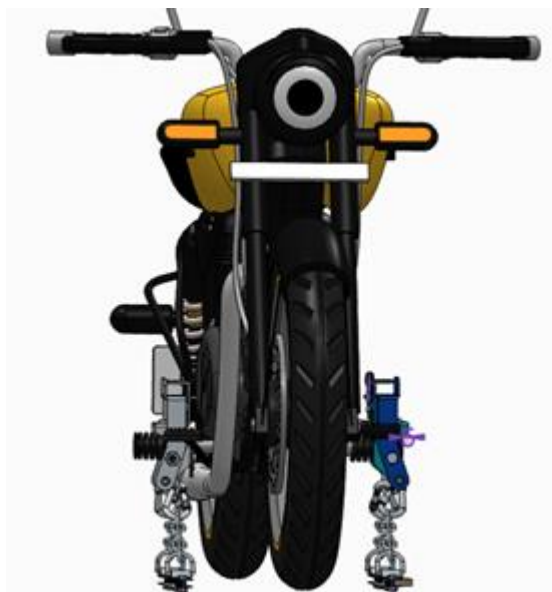
Рис 4. Вид спереди. Мотоцикл зафиксирован креплениями PBTech Light.
