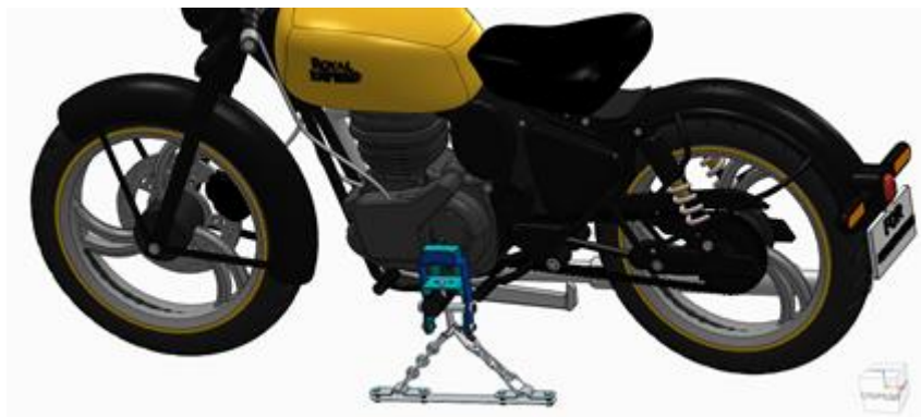
Рис 3. Правильное расположение левого крепления PBTech Light.
