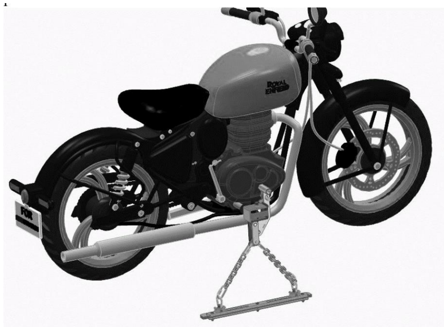
Рис 3. Правильное расположение правого крепления PBTech Light.
