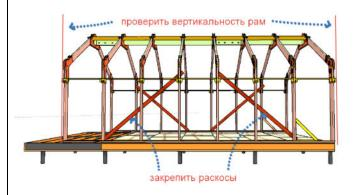
Доска сухая, строганная хв/п. 45х90 мм (силовая обрешетка силового каркаса)
